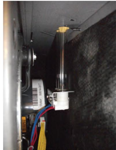
4. À l'aide d'une douille de 5/16", enlevez les deux vis qui se trouvent sur le côté du support de l'ampoule. Le support est maintenant dégagé, ce qui vous permet d'enlever l'ampoule.
