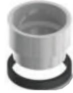
Le raccord de la prise d'air comburant consiste en une douille de 2" en PVC fixée à un adaptateur fileté. Déterminez l'emplacement de la prise d'air et enlevez le capuchon de plastique approprié. Installez l'adaptateur sur le panneau extérieur, en utilisant le joint d'étanchéité (ce dernier étant placé à l'extérieur du panneau et l'écrou de blocage à l'intérieur). **La garantie sera annulée si vous omettez d'installer le joint d'étanchéité sur l'extérieur du cabinet.**
