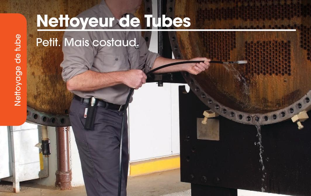
Conçu avec la portabilité à l'esprit, ce nettoyeur de tubes compact propose les fonctionnalités innovantes dont vous avez besoin et apporte les avantages attendus d'un produit SpeedClean. Rincage à l'eau intégré, tige rotative 860 l/min dans les deux sens, tiges et brosses à connexion rapide – le tout avec un encombrement moitié moindre que celui des nettoyeurs classiques. Bonne nouvelle.
