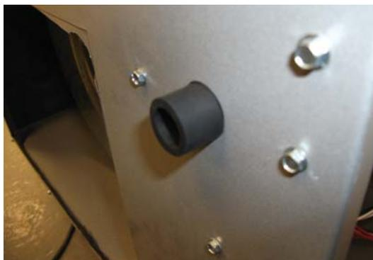
3. Un raccord ou un adaptateur de 1/2" s'ajustera parfaitement sur le tuyau de caoutchouc de 1/2". Un raccord ou un adaptateur de 3/4" s'ajustera parfaitement sur le tuyau de 5/8". Cette méthode assure l'étanchéité de l'ensemble tout en permettant d'enlever facilement le purgeur de condensat aux fins d'entretien.
