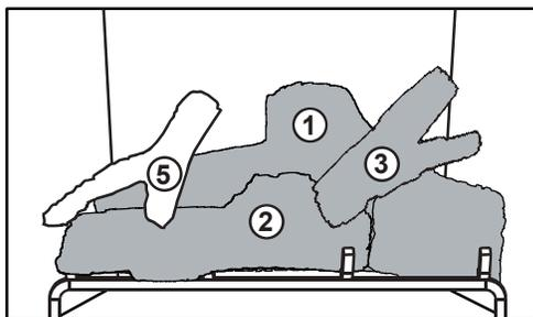
**E.** Placez l'entaille de la bûche n° 5 (FIG 2) sur l'empreinte ou l'indentation supérieure gauche de la bûche n° 1. Assurez-vous que la butée de la bûche n° 5 s'appuie sur le côté gauche de la bûche n° 2.
