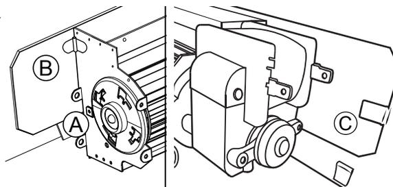
De la poussière de gypse pourrait pénétrer dans les roulements de la soufflerie, causant des dommages irréparables. Des précautions doivent être prises pour éviter que cette poussière entre en contact avec la soufflerie ou avec son compartiment. Tout dommage résultant de cette situation n'est pas couvert par la politique de garantie.
