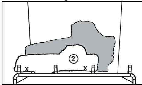
**B.** Placez les 2 entailles de la partie inférieure de la bûche n° 2 (représentée ci-dessus par un X) sur les pieds de positionnement du brûleur **PHAZERAMIC™**.
