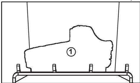
**A.** Placez la bûche arrière n° 1 sur les supports de positionnement le long du bord arrière du brûleur **PHAZERAMIC™** en vous assurant de la centrer sur le boîtier de veilleuse.
