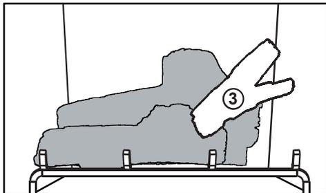
**C.** Placez l'entaille de bûche n° 3 sur l'empreinte ou l'indentation supérieure droite de la bûche n° 1. Assurez-vous que le butée de la bûche n° 3 s'appuie sur le côté droit de la bûche n° 2.
