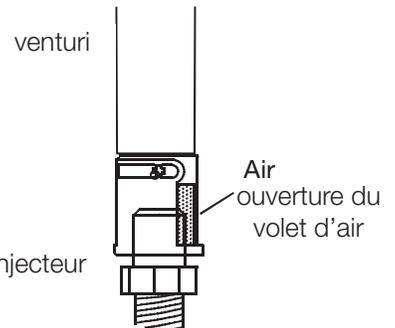
**LE RÉGLAGE DU VOLET D'AIR DOIT ÊTRE EXÉCUTÉ PAR UN TECHNICIEN OU INSTALLATEUR QUALIFIÉ.**
