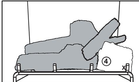
**D.** Placez l'entaille avant de la bûche n° 4 (représentée ci-dessus par un X) sur la quatrième tige du chenet en l'appuyant le long du bord du brûleur contre le panneau de brique. Assurez-vous de laisser un écart de 1/2 po entre la bûche n° 2 et la bûche n° 4 pour éviter les problèmes d'allumage. N'obstruez pas les orifices.
