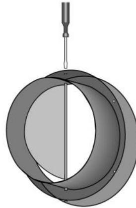
Poussez et tournez avec un tournevis à lame plate. Le registre se bloque automatiquement lorsqu'on relâche la pression.
