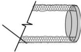
Lorsque vous raccordez la canalisation au collier, prenez note de l'emplacement des vis. Ces vis devraient être placées pas plus loin que 1/2 po du bord extérieur du collier, afin de ne pas entraver le déplacement du registre.
