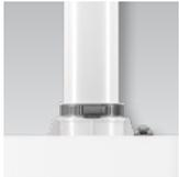
**Options de ventilation multiples.** La faible température des gaz d'évacuation permet l'utilisation de systèmes d'évents en PVC, en PVC-C, en polypropylène (rigide et flexible) et en acier inoxydable, ce qui réduit les délais et les coûts d'installation. Le système peut utiliser des évents de 2" jusqu'à 60' ou des évents de 3" jusqu'à 150'.
