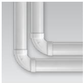
**La faible température des gaz d'évacuation** permet l'utilisation de systèmes d'évents en PVC, en polypropylène (rigide et flexible) et en acier inoxydable, ce qui réduit les délais et les coûts d'installation. Le système peut utiliser des évents de 2" jusqu'à 60' ou des évents de 3" jusqu'à 150'.
