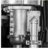
**Venturi double et conversion sur le terrain.** Le système à venturi double permet un meilleur contrôle de la combustion et un taux de modulation accru. Plaquette multiorifice pour la conversion facile entre le gaz naturel et le propane liquide. Trousse de conversion incluse avec toutes les chaudières de la série NFB-C.
