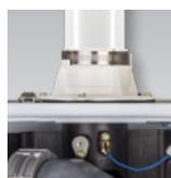
**Événements en PVC.** La faible température des gaz d'évacuation permet l'utilisation de systèmes d'événements en PVC, en PVC-C, ULC S636 et en polypropylène, ce qui réduit les délais et les coûts d'installation. Le système peut utiliser des événements de 2" jusqu'à 60' ou des événements de 3" jusqu'à 150'.
