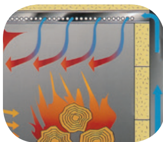
Le conduit d'air secondaire en acier inoxydable qui produit un déploiement extraordinaire de FLAMMES JAUNES DANSANTES .
