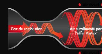
Le système de turbulence Vortex™ à l'intérieur de l'échangeur de chaleur augmente l'efficacité en perturbant la circulation naturelle de l'air, ce qui permet d'extraire un maximum de chaleur des gaz de combustion.
